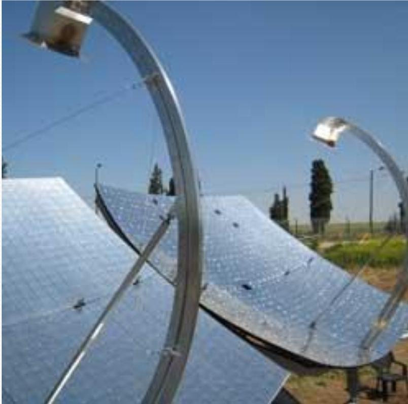
Les miroirs concentrent les rayons du soleil sur une cellule photovoltaïque pour la conversion de la lumière en électricité
